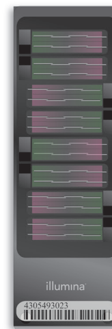
Abbildung 1: Der Infinium MethylationEPIC BeadChip v2.0: Der Infinium MethylationEPIC BeadChip v2.0 enthält über 935.000 CpG-Stellen in Enhancer-Regionen, Genkörpern, Promoter-Regionen und CpG-Inseln.
