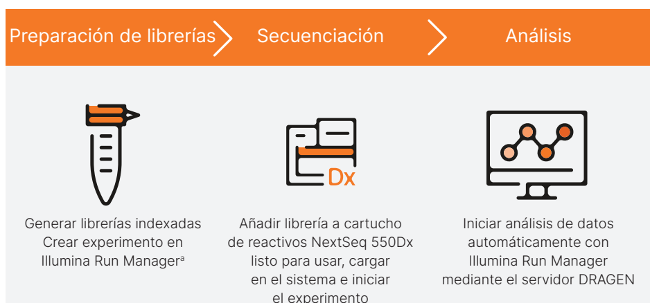
Figura 2: El proceso de ensayo de NextSeq 550Dx en tres pasos: el instrumento NextSeq 550Dx forma parte de un flujo de trabajo integrado de tres pasos. Con el ensayo Illumina DNA Prep with Enrichment Dx se pueden obtener informes detallados de los resultados.
