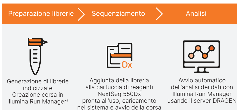
Figura 2: processo in tre fasi del saggio NextSeq 550Dx. NextSeq 550Dx Instrument si inserisce in un flusso di lavoro integrato costituito da tre fasi. Con il saggio Illumina DNA Prep with Enrichment Dx sono disponibili report dettagliati sui risultati.
