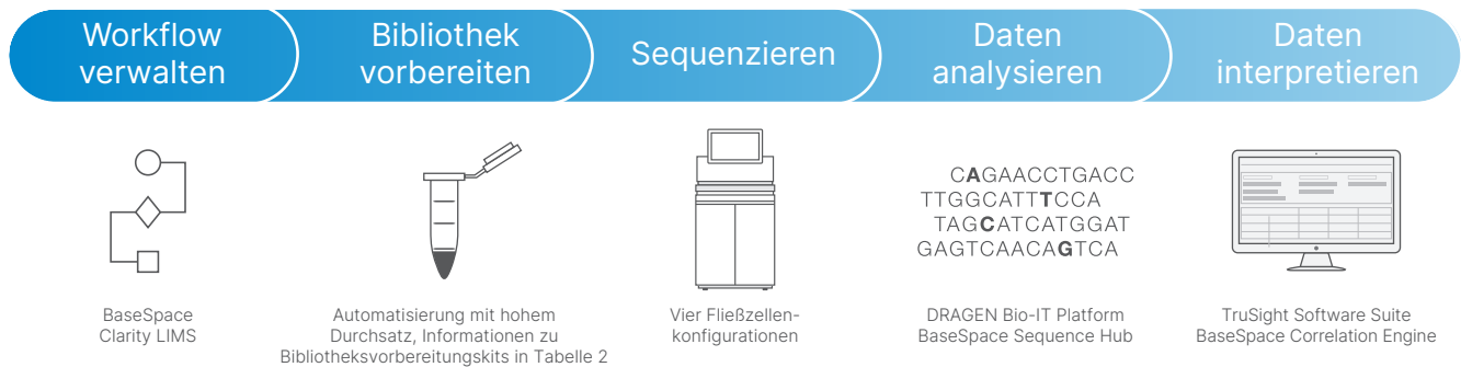
Abbildung 4: NGS-Workflow mit dem NovaSeq 6000 System: Das NovaSeq 6000 System ist mit BaseSpace Clarity LIMS, dem Portfolio der Bibliotheksvorbereitungskits von Illumina, dem Illumina Qualified Methods-Support, mit Datenanalyselösungen wie der DRAGEN Bio-IT Plattform und BaseSpace Sequence Hub sowie Tools für die nachgeschaltete Dateninterpretation wie der TruSight Software Suite und der BaseSpace Correlation Engine kompatibel.
