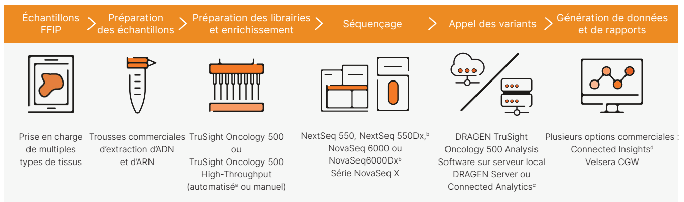
Figure 2 : Flux de travail du test TruSight Oncology 500 : TruSight Oncology 500 et TruSight Oncology 500 High-Throughput s'intègrent dans les flux de travail de laboratoire actuels, allant des acides nucléiques aux appels de variants en quatre jours.
